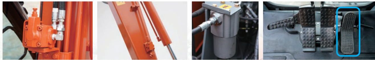
配备二次溢流阀，缓解破碎作业对液压系统的冲击。 斗杆前端配有附件专用截止阀，在不连接附件时截断油路。 破碎锤专用高性能回油滤清器，保护液压部件。 配备破碎锤作业专用踏板，提高作业效率。
